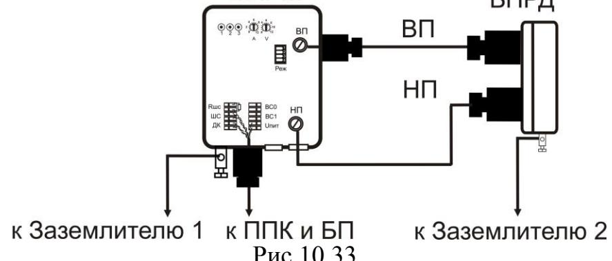
*значение Rис определяется сопротивлением, необходимым для поддержания ДЕЖУРНОГО РЕЖИМА приемно-контрольного прибора; 3) Диаметр сечения проводов, подключаемых к зажимам не должен превышать 2,5мм.*
